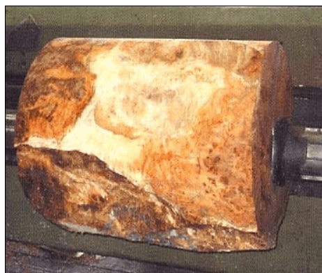
Populieren maserstam vast in de pinolen van een RFR schilmachine.
