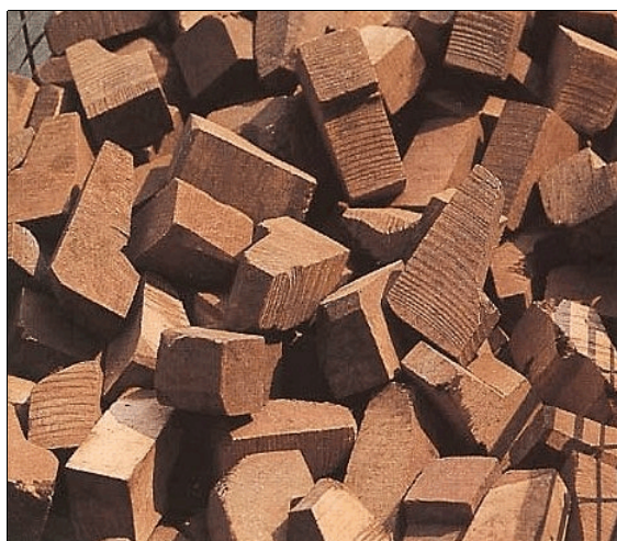
De ruwe pijpvormen, 'ébouchons', moeten de vele bewerkingen nog ondergaan. Ieder blokje weegt tussen de 50 en 100 gr.
